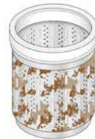
洗濯槽の汚れ
